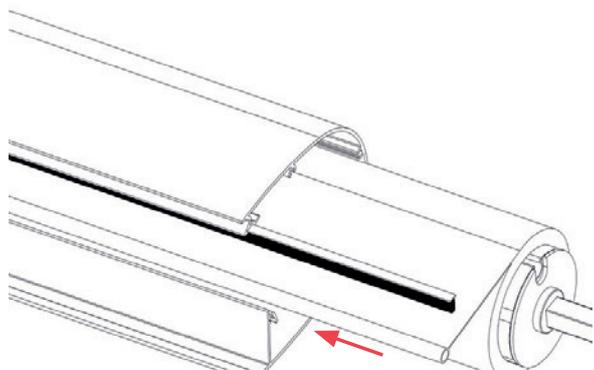
Meter el eje con lona y casquillos dentro del perfil cajón. Meter también el felpudo en el perfil cajón cortando el felpudo sobrante.
