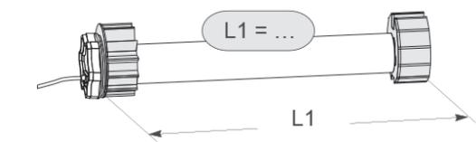
2.1.2 Medir la longitud (L1) entre el borde interior de la cabeza del motor y el extremo de la rueda.
