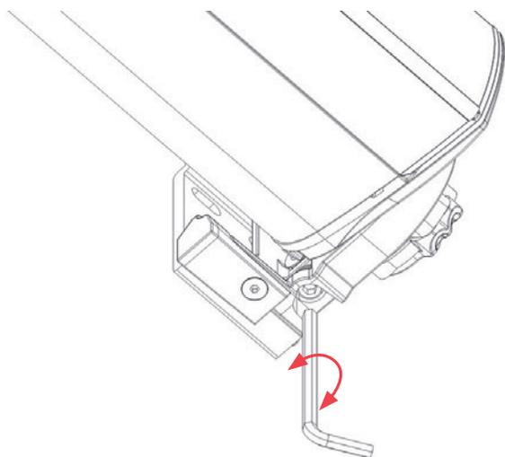
Regular la inclinación del cofre y después, apretar los soportes fijos (tornillos M6).
