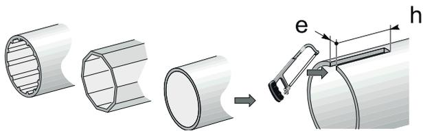
2.2.3 En tubos lisos, realice una muesca según las dimensiones indicadas: - e = 4 mm - h = 28 mm.
