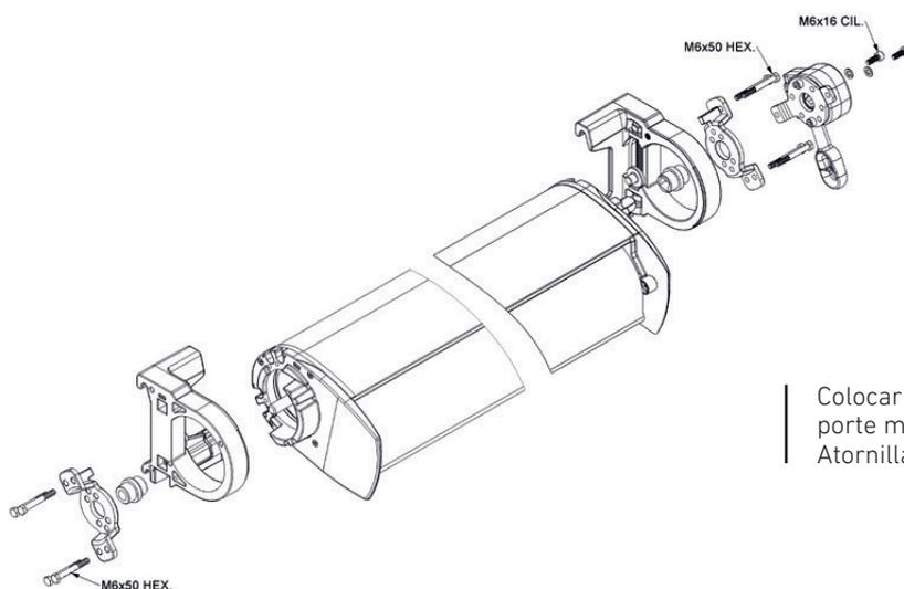
Colocar con los tornillos M6 para sujetar las piezas al soporte móvil y posteriormente al soporte móvil. No apretar. Atornillar la máquina en su soporte y posteriormente.
