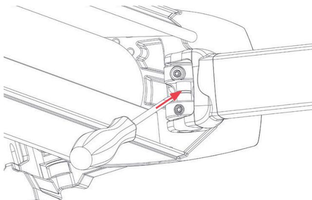
Detalle de la extracción del eje en caso de desmontaje.
