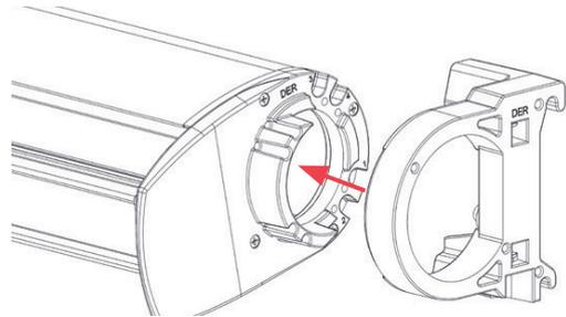
En el extremo motor, atornillar al soporte punto, ensamblar el soporte fijo (extremo del cofre que llevará el motor), con el soporte móvil y finalmente, introducir el conjunto soporte/motor en el eje. Con los tornillos M6, atornillar los tres soportes.
