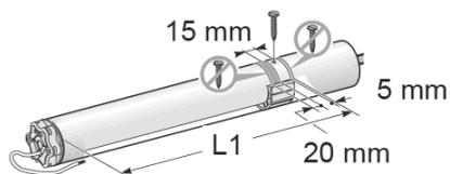
2.3.2 Por motivos de seguridad, fije el tubo de enrollamiento en la rueda con 4 tornillos Parker de  $\varnothing 5$  mm o 4 remaches Pop de acero de  $\varnothing 4,80$  mm situados:
