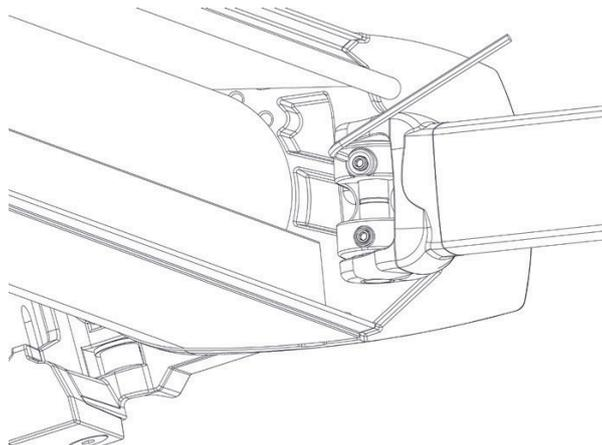
Actuar en la regulación de la altura del codo para asegurar que cierra perfectamente el cofre (antes de regular en caso de estar usando la máquina, sujetar los brazos con su funda y soltar la lona accionando la máquina).
