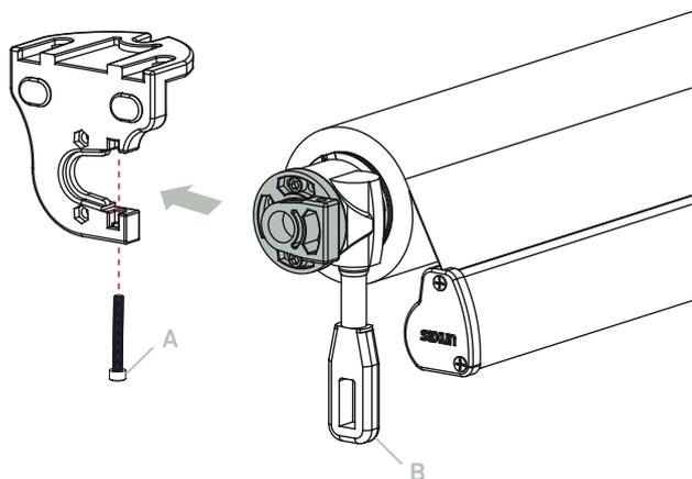
Colocar en el soporte el guía máquina con la misma colocada, **B**, y sujetar con el tornillo **A**.
