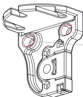
Cuando la fijación se desea entre paredes, deben perforarse los agujeros premarcados en el soporte **C** e introducir los correspondientes anclajes.
