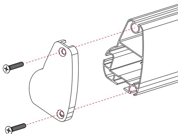
Colocar las tapas embellecedoras laterales de dicho perfil, sujetando con los mismos tornillos que anclan la tapa y el tejido en los extremos.
