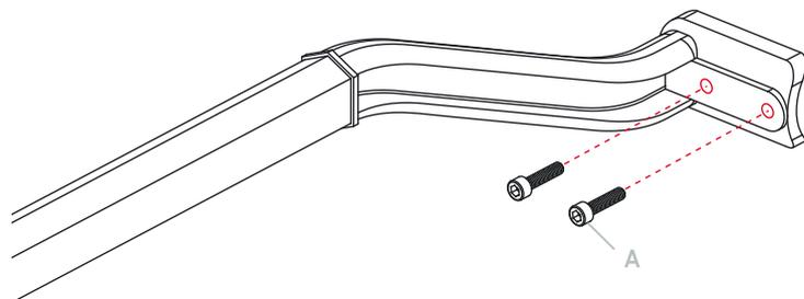
Insertar los dos tornillos Allen **A** de la regleta por los orificios del terminal y sujetarlos a la citada regleta.
