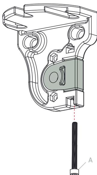
Colocar en uno de los soportes el guía punta, sujetándolo con el tornillo **A** que se sujeta en la tuerca ya insertada en el propio soporte.
