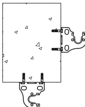
Posicionar los soportes (a techo o frontal) a la distancia correcta. Para ello medir la línea del toldo ensamblado (de soporte a soporte). Ambos soportes deben estar posicionados al mismo nivel.
