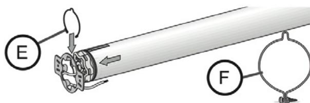
**3.4.3** En función del tipo de soporte, instale el anillo de tope (E) (en el caso de los motores  $\geq 85$  Nm, con un anillo de tope se utiliza obligatoriamente el anillo de tope bloqueable (F).
