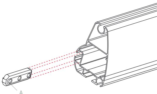
Insertar en la ranura lateral del perfil delantero **TOLPER** la regleta **A** que sujetará el terminal.
