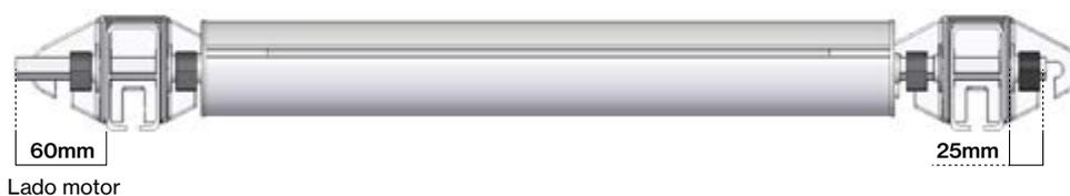
Finalmente, se montará el motor introduciendo el extremo libre del eje cuadrado por el casquillo del tubo de transmisión del motor y fijando su otro extremo a la estructura o pared mediante la escuadra soporte.
