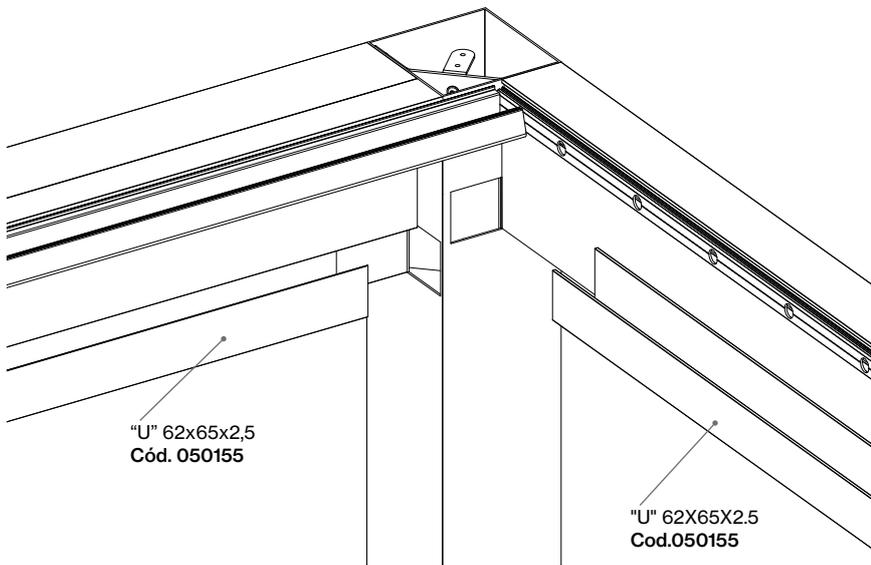
Instalar los canales de desagüe "U" en las vigas **izquierda** y **derecha**, introduciendo para ello el extremo del canal por el orificio de desagüe mecanizado en las columnas A y B y enrasarlo con la viga y las columnas C y D
