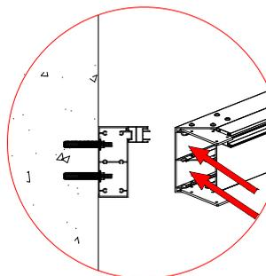
Utilizar los extremos cortados a inglete de la viga para realizar los orificios que permitan la fijación de la viga de cierre al muro. Verificada la altura y su nivelación, instalar la viga en el muro.
