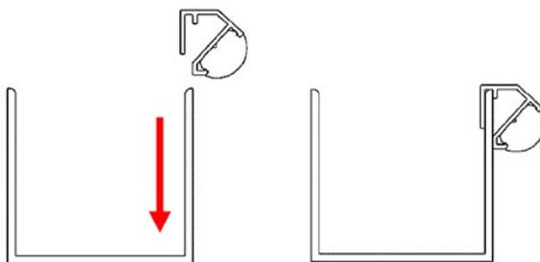
En las **esquinas de la pérgola con columna**, colocar la pieza para la esquina de LED perimetral que aparece en la imagen a la derecha.
