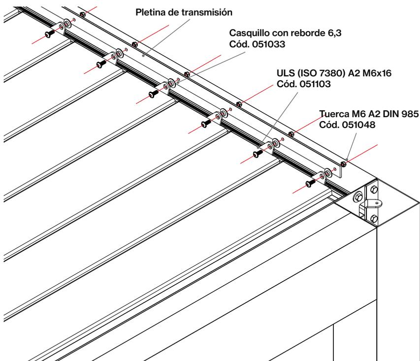
Unir las pletinas a los testeros con sus correspondientes tornillos ULS (ISO 7380) A2 M6x16, casquillos de plástico con reborde 6,3 mm y tuerca M6 DIN 985.
