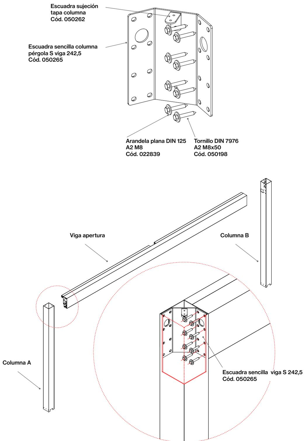
Teniendo las vigas de apertura y cierre unidas a las columnas, fijarlas sobre las bases de columna de superficie de la solera por medio de los tornillos ULS (ISO 7380) A2 M6x16 mm. Como muestra la imagen.
