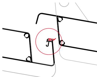
1.9 Instalación de canales de desagüe "U" en vigas de apertura-cierre-centrales y laterales
