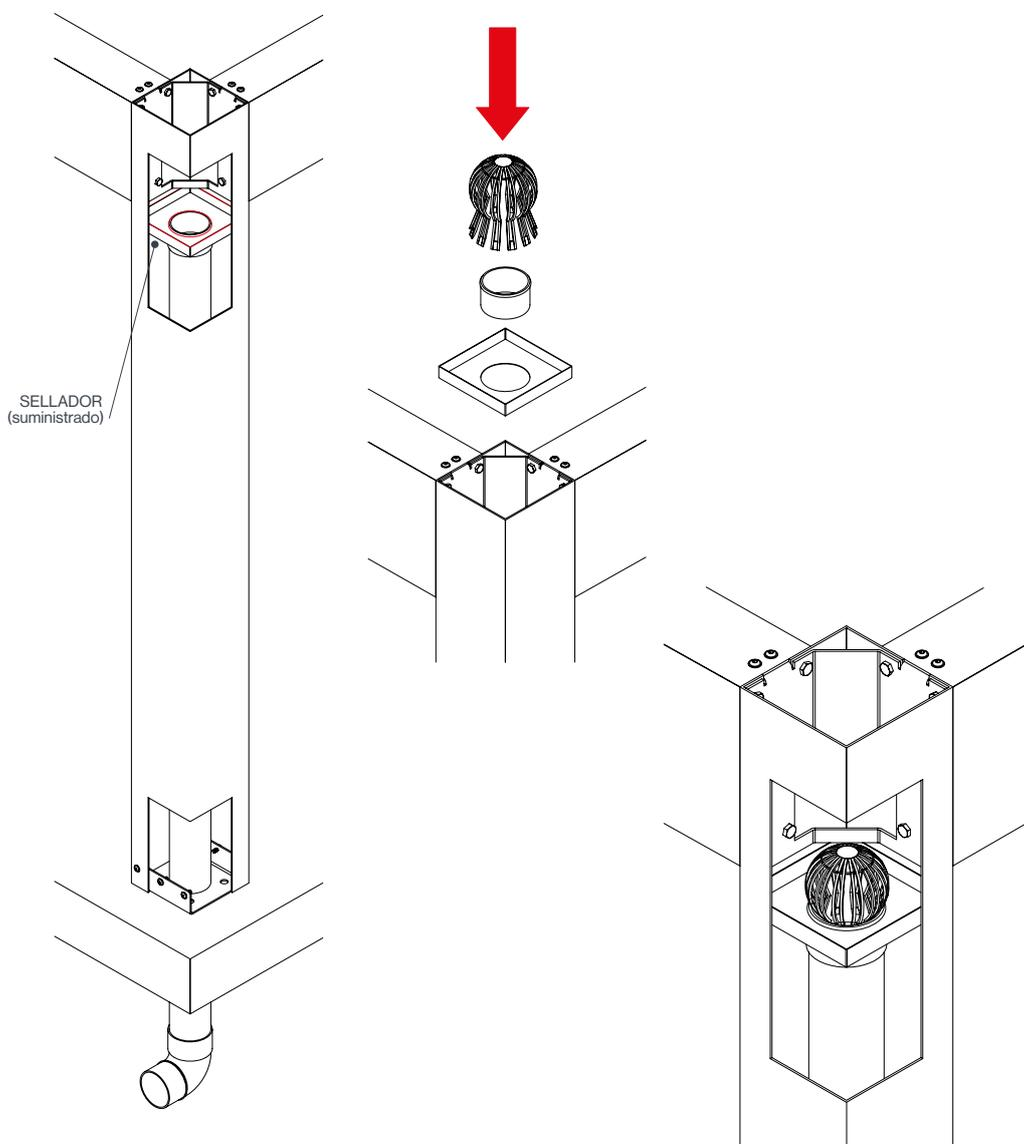
Para terminar, aplicar el sellador (suministrado) por todo el perímetro de la bandeja recolectora y del adaptador. Como se muestra en la imagen (sellador en rojo) e introducir en el adaptador el parahojas universal.
