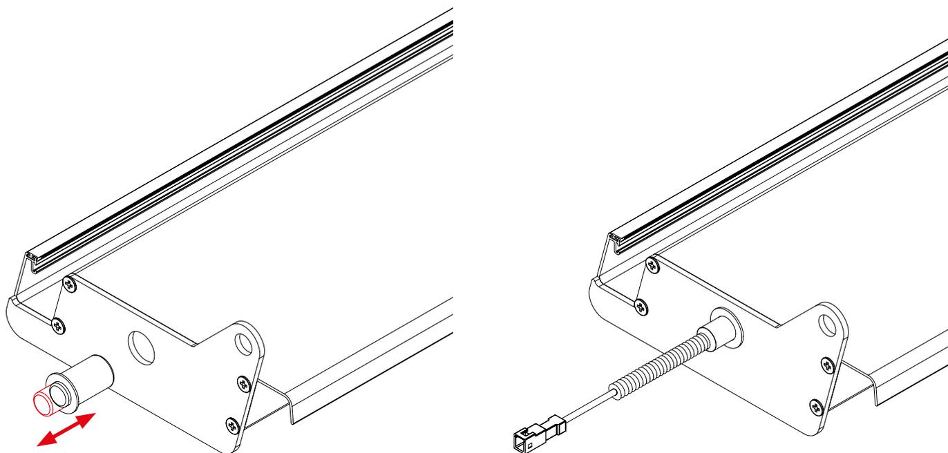
Para la instalación de las lamas con LED, vendrán ya pre-instaladas en un lado con un eje hueco por el cual sale el conector de LED con un muelle de protección y en el otro lado habrá que poner el eje retráctil O-210.
