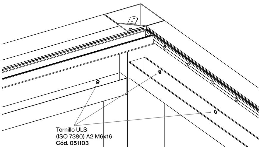
Comprobar que todos los orificios del perfil "U" coinciden con los mecanizados de M6 de las vigas.
