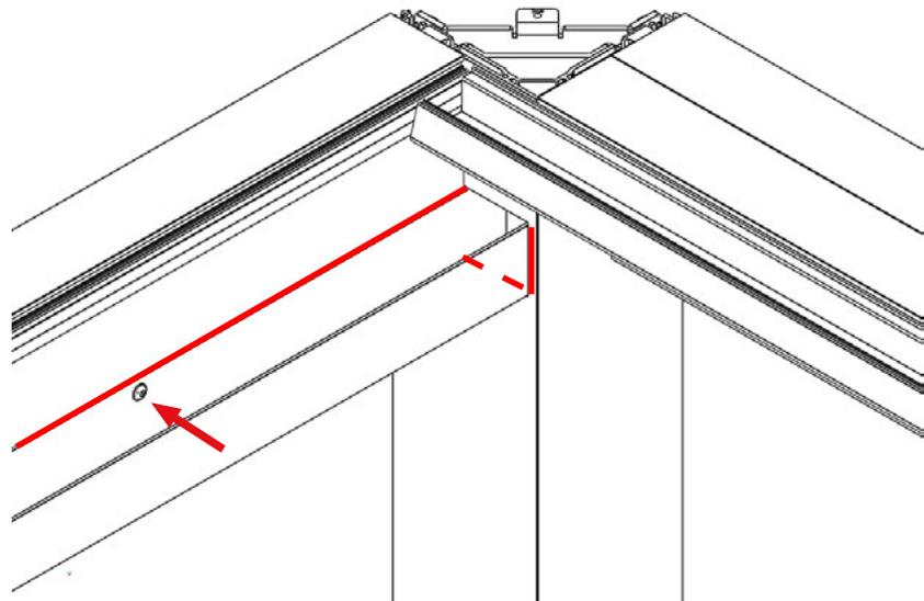
Comprobar que todos los orificios del perfil "U" coinciden con los mecanizados de M6 de las vigas. Si todos coinciden, aplicar sellador entre el perfil "U" y la viga, así como alrededor de los orificios de los tornillos, después atornillar los perfiles por medio de los tornillos ULS (ISO 7380) A2 M6x16.
