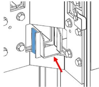
3. Cuando se coloque la pieza, esta debe hacer tope con el extremo del canalón como se señala en la imagen.
