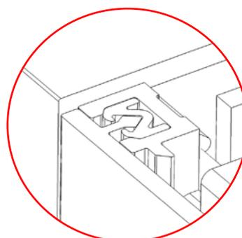
En la parte superior del clipaje derecho, desatornillar ligeramente el tornillo de la pieza de acople del perfil embellecedor, para poder colocar el perfil en su sitio. A continuación, volver a atornillar hasta que la columna se quede totalmente cerrada.
