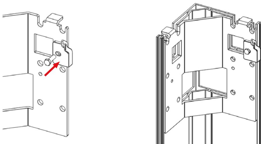
Comprobar la nivelación de la viga de cierre con respecto a la base, su altura con respecto al plano y que todos los marcajes con respecto a las fijaciones de las bases están a 90°. La instalación correcta de la viga y bases de las columnas son cruciales para un óptimo funcionamiento de la pérgola.
