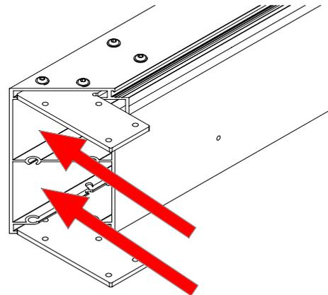
Comprobar la nivelación de la viga de cierre con respecto a la base, su altura con respecto al plano y que todos los marcajes con respecto a las fijaciones de las bases están a 90°.
