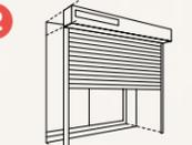
Introduce la estructura en el hueco de la ventana o puerta.
